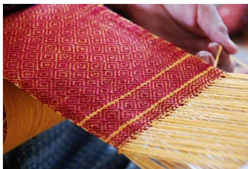
ภาพที่ ๔ การสานขัดกันของด้ายยืนและด้ายพุ่ง
